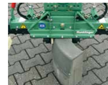
Quergreifen Radensteine setzen oder Borde aufnehmen
